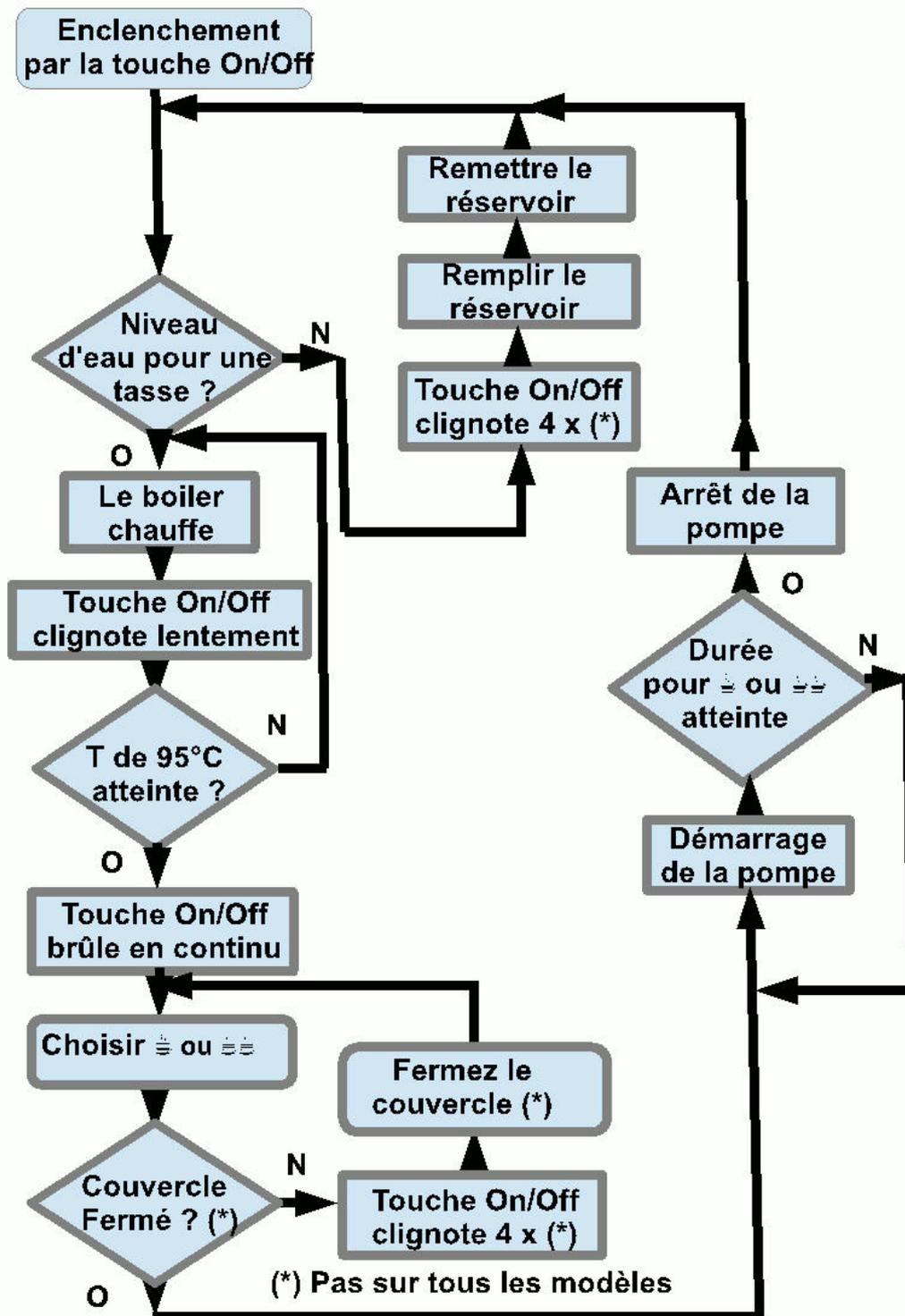
Schéma du fonctionnement global du software d'une Senseo
