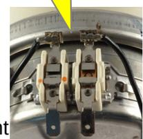
L'interrupteur thermique se trouvant généralement à droite, est connecté à la double borne par une partie centrale couleur cuivre. Si cette panne est constatée, il est sage de remplacer le boiler avec le thermostat de sécurité. Les fils de raccordement à l'élément chauffant sont généralement soudés par points et par conséquent difficiles à reconnecter en toute sécurité. voir aussi les images ci dessus de ce thermostat de sécurité
