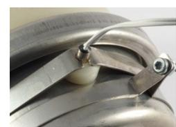
Cette résistance a pour caractéristique d'être à coefficient de température négatif (CTN). C'est-à-dire que sa résistance diminue lorsque la température augmente. La résistance à température ambiante est d'environ 10 k $\Omega$ . A 95 °C, elle est d'environ 2 k $\Omega$ . Si vous prenez le capteur dans la main la diminution de la résistance doit déjà être mesurable.
