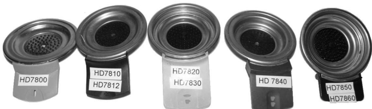
Le modèle avec un trou au milieu se retrouve dans les plus vieilles Senseo. Les premiers modèles avec un seul trou étaient sujets à bouchage par des grains de café. Les modèles munis d'un tamis au-dessus du trou sont moins sensibles à l'encrassement. En cas de remplacement, le modèle doit être exactement le même. Notez la profondeur de la saillie vers le bas. Une mauvaise version peut avoir pour effets : l'absence de mousse sur le café ou des fuites.
