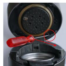
Réassemblage de la coiffe du couvercle. Premièrement, mettre l'avant dans son clip de fixation et ensuite l'arrière dans ses deux clips. Pressez bien la coiffe jusqu'à ce que vous entendiez les 2 clics.
