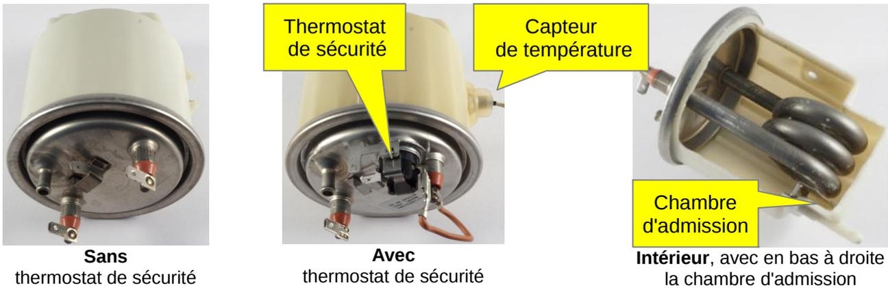
Dans le boiler avec thermostat de sécurité, il y a une sécurité supplémentaire. Si le chauffage de l'eau n'est pas coupé par l'électronique dans le cas de panne, il sera coupé par le thermostat de sécurité. Cela se passe à la température d'environ 105 °C. Aussitôt que l'eau du boiler descend à environ 90 °C, le thermostat de sécurité rétablira le courant dans le boiler.
