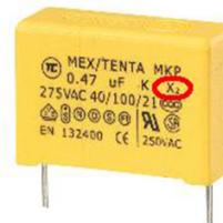
Dans un condensateur standard MKP/MKx (en jaune ci dessus), une panne interne peut induire un court-circuit qui appliquera la tension de 230 V directement au module électronique de la Senseo. Il y a alors de fortes chances que le module soit détérioré ou même qu'un incendie se déclenche.
