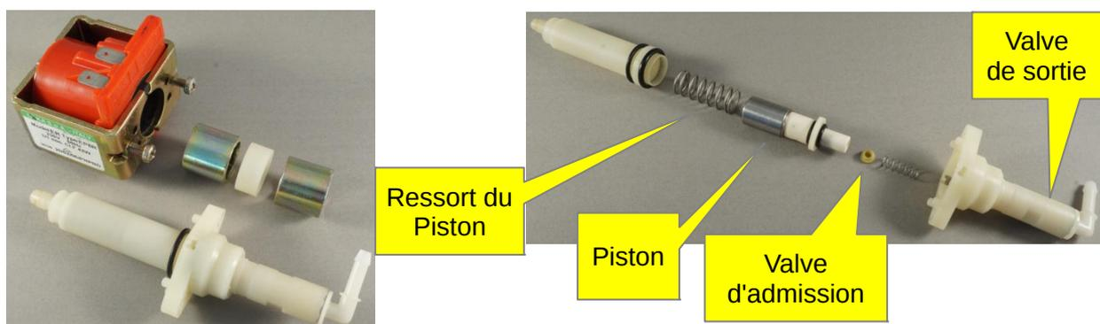
L'intérieur de la pompe : dans la pratique, la perte de pression et les fuites d'eau sont dues au détartrage avec utilisation de vinaigre. Les pièces en caoutchouc de la pompe ne sont pas résistantes à l'acide acétique.
