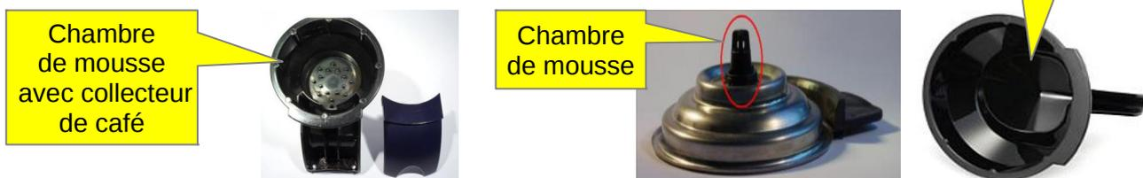
La chambre de mousse est l'endroit où la couche de mousse se forme sur le café. Cette couche de mousse, aussi nommée "Crème", est créée dans la Senseo par la pulvérisation du café, suite à l'action de la pression exercée sur le café chaud à travers le petit trou du porte-dosettes et, le fait que le mélange air-café ainsi obtenu est récolté sur une surface plane.
